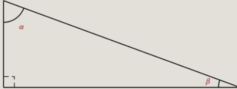
Si  $\alpha$  y  $\beta$  son los ángulos agudos de un triángulo rectángulo, entonces  $\alpha + \beta = 90^\circ$ .
