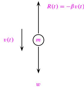
Consideramos que la dirección positiva es hacia abajo y que  $t \geq 0$ , a partir de que el paracaídas se abre. La resistencia del aire es  $R$  y se cumple que  $|R| = \beta |v(t)|$ , con  $\beta > 0$ , y  $R = -\beta v(t)$ . Tenemos:
