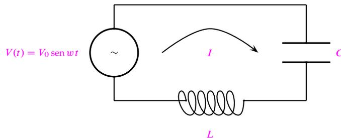
Un circuito LC simple de corriente alterna, como el de la figura anterior, está formado por una fuente de voltaje  $V(t)$ , un capacitor  $C$  y un inductor  $L$ . Las caídas de potencial en el circuito son  $Q/C$  sobre el capacitor y  $L \frac{dI}{dt}$  sobre el inductor. De acuerdo con la ley de Kirchhoff de voltaje, tenemos que
