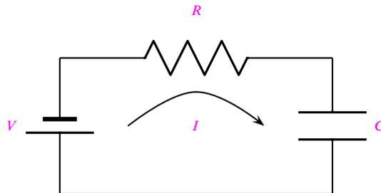
En esta figura se muestra un circuito RC de corriente continua, el cual está formado por una malla simple con una fuente de voltaje  $V$  constante, un resistor  $R$  y un capacitor  $C$ . Cuando se conecta la fuente, las caídas de potencial ocurren en el resistor  $RI$  y en el capacitor  $Q/C$ . De acuerdo con la ley de Kirchhoff de voltaje, tenemos entonces que
