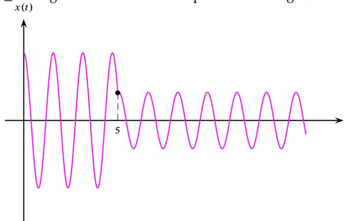
En la gráfica resulta notoria la perturbación que se imprime al sistema en el tiempo  $t = 5$  s por efecto del impulso aplicado. Obsérvese que, en ese momento, la masa está debajo de la posición de equilibrio y se va dirigiendo hacia esta posición cuando recibe un golpe justo en la dirección contraria, lo que explica por qué la oscilación se aminora y además por qué se aprecia en ese instante un cambio abrupto en la dirección tangencial sobre la gráfica.
