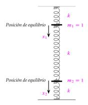
Este modelo comprende dos variables  $x_1(t)$  &  $x_2(t)$ . Es de esperarse que el modelo requiera de un sistema de ED.
