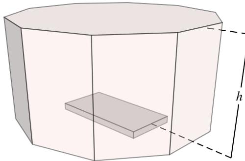
Considerar que el fluido y la placa rectangular se encuentran en reposo. Además,  $h$  es la distancia entre la parte superior de la placa y el nivel del fluido y el fluido tiene una densidad  $\rho$  (kilogramos por metros cúbicos). El área de la superficie superior de la placa es  $A$  (metros cuadrados).
