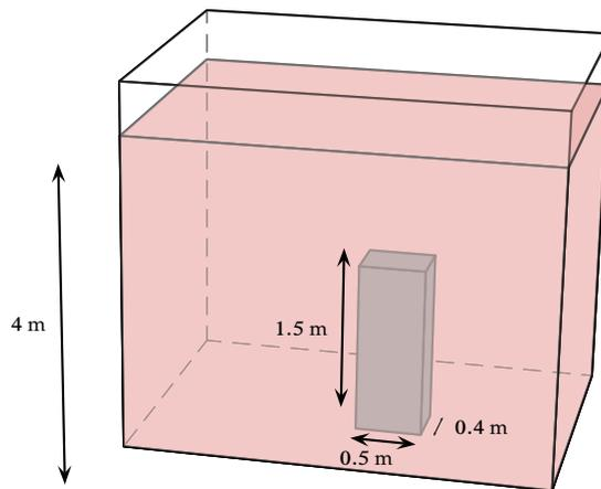
2. Una placa delgada vertical está sumergida en un contenedor con agua como se ve en la siguiente figura. Encontrar la fuerza total del fluido sobre la superficie de la placa.
