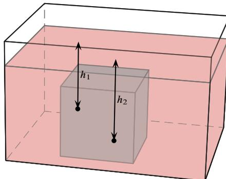
Observe que no todos los puntos sobre las superficies verticales del poliedro se encuentran a la misma profundidad con respecto del nivel del fluido. No en todos los puntos sobre estas superficies se tiene la misma presión  $P$  ( $P = \rho gh$ ). En los distintos puntos de la superficie, el fluido va a ejercer fuerzas diferentes.
