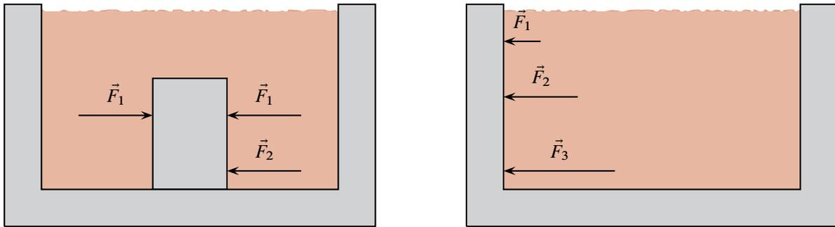
De la expresión para calcular la fuerza de un fluido sobre una superficie  $F = \rho Ahg$  se puede apreciar lo siguiente: si toda la superficie de un objeto sumergido en un fluido se encuentra a la misma profundidad sobre el nivel del fluido, la fuerza del fluido sobre todos los puntos de dicha superficie es la misma. Es evidente que se trata de una superficie horizontal y tanto la fuerza como la presión del fluido se pueden calcular con facilidad.
