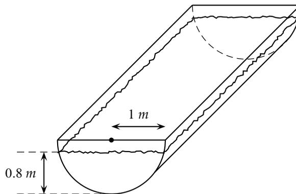
En el contenedor se encuentra aceite de motor (densidad:  $890 \text{ kg/m}^3$ ) cuya altura es de 80 cm. ¿Cuál es la fuerza que ejerce el líquido sobre una de las paredes verticales del contenedor?
