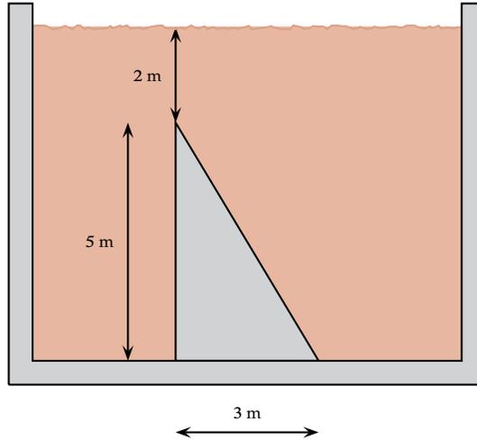
3. ¿Cuál es la fuerza hidrostática que actúa sobre una compuerta rectangular situada en la parte inferior de la cortina vertical de una presa?
