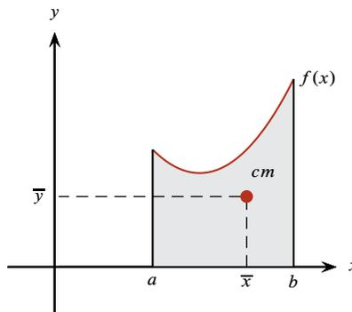
Como se puede apreciar, la placa está delimitada por las rectas  $x = a$ ,  $x = b$ ,  $y = 0$  y por la gráfica de la función  $f(x)$  [continua en  $(a, b)$ ]. ¿Cómo calcular las coordenadas  $\bar{x}$  &  $\bar{y}$  del centro de masa ( $cm$ ) de la placa?
