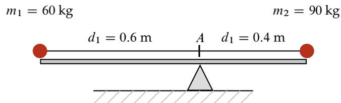
Como se puede apreciar, la varilla tiene una longitud de un metro y se encuentra apoyada en el punto  $A$ . En un extremo se encuentra la masa  $m_1$  y en el otro la masa  $m_2$  a una distancia de 0.6 m y 0.4 de  $A$ , respectivamente.
